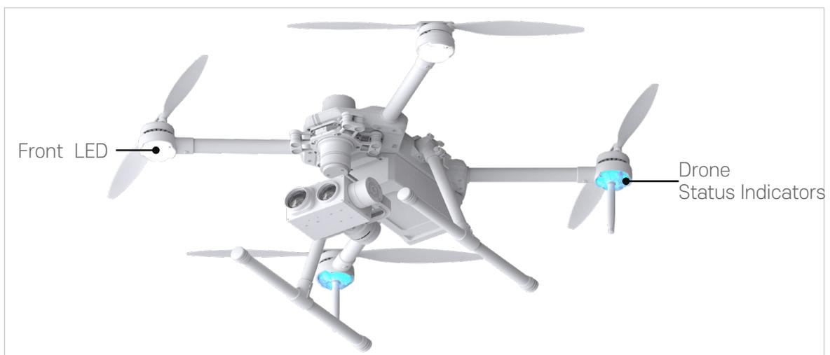
Die vorderen LEDs zeigen die Ausrichtung der Drohne an. Die vorderen LEDs leuchten grün, wenn die Drohne eingeschaltet ist, um die Vorderseite (oder Nase) der Drohne anzuzeigen. Die Drohnenstatusanzeigen geben den Systemstatus des Flugcontrollers an. Weitere Informationen zu den Drohnenstatusanzeigen finden Sie in der folgenden Tabelle.
